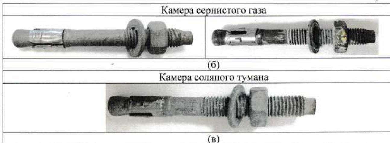
Рис. 2. Внешний вид анкеров ФИКСАР АНК после испытаний в камерах влажности (а), сернистого газа (б) и соляного тумана (в).
