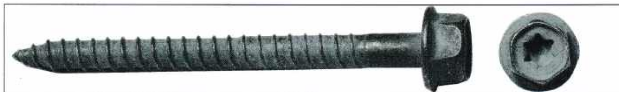
Рис. 1 Образцы шурупов 7*85, поступившие на исследование
