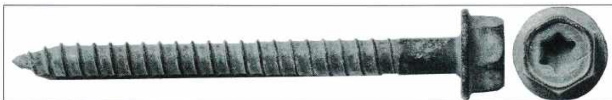
Рис. 2 Внешний вид шурупов после испытаний в камере сернистого газа в течение 720 ч
