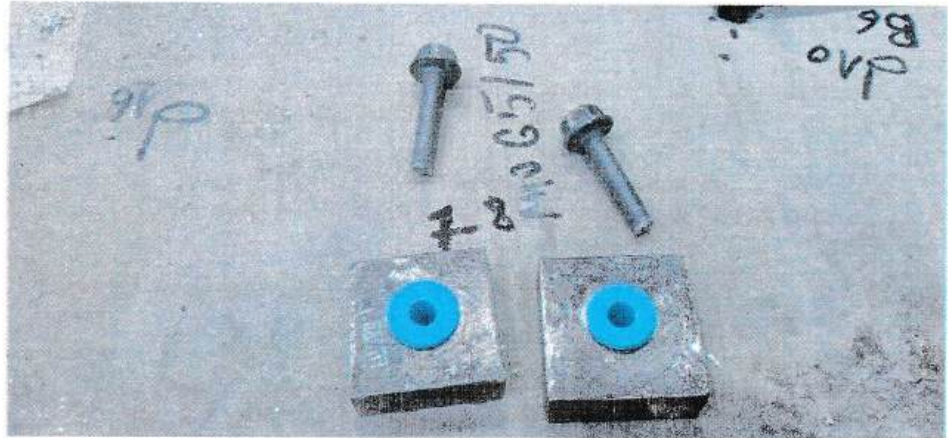
Рисунок 3. Характер разрушения образца – разрушение анкера по стали
