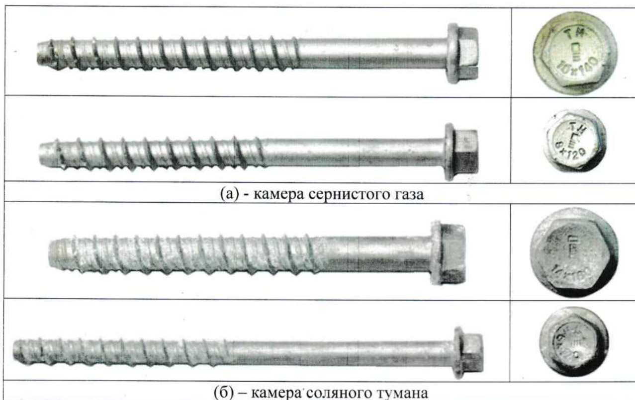
Рис. 2 Внешний вид образцов после испытаний в камерах сернистого газа (а) и соляного тумана (б) в течение 30 суток
